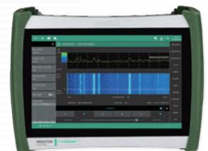
基本的なスペクトラムアナライザで3 GHzまでの周波数をカバー。10インチ大型ディスプレイは、タッチパネルとなっており、スマートホンのような直感的な操作と良好な視認性を確保しながら、耐衝撃規格 IK08に対応。また、入力耐電圧5 W、ソフトキャリングケースに収納した状態でIP52の防塵防滴とフィールドでの使用にも安心してご使用いただけます。
